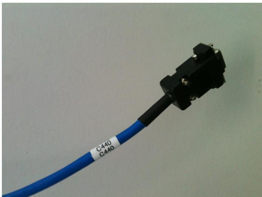
Este cabo 440 serial DB-9, esta instalado dentro do quadroo próximo ao controle de entrada. Esse cabo será conectado a um notebook, através de um cabo USB/Serial.
